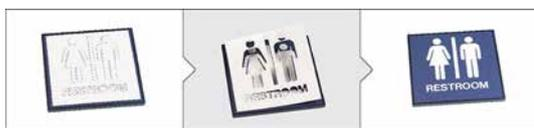
1º) Pegar una capa de espesor 0,8 mm (1/32") sobre otra capa de espesor 1,6 mm (1/16") o 3,2 mm (1/8").
